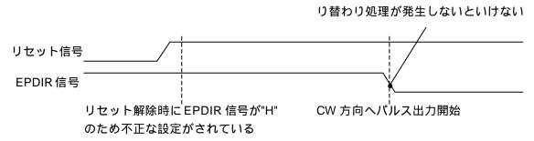
「エンコーダ方向」が CW 方向に設定されているため、本来なら検出すべきエンコーダ方向の切り替えが行われず「エンコーダ状態」が CCW 方向のまま保持されてしまう。このためエンコード値を CCW 方向で算出するため不正な値が報告される。
